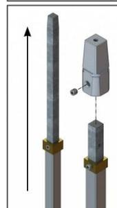
Gewindestift des Stelling lösen, Schlüsselstange auf gewünschte Rohrdeckung einstellen und wieder fixieren
