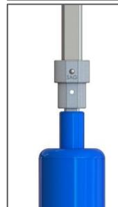
Schlüsselstange mit Kuppelmuffe so auf Armatur setzen, dass Bohrung der Kuppelmuffe und Bohrung der Spindel zueinander fluchten
