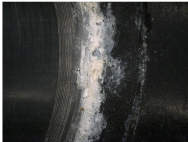
Abbildung 5: Zinkkorrosion im Bereich Spindelvierkant-Zinkdruckguss-Einleger
