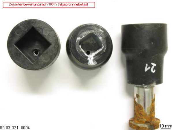
Abbildung 4: Hybridkuppelmuffen nach 100 Stunden Salzsprühtest [2]
