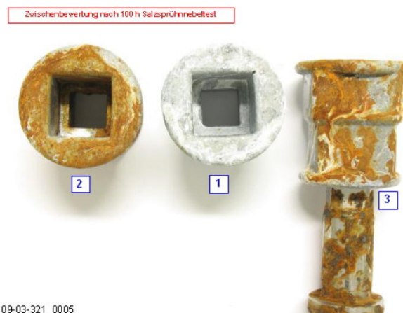
Abbildung 3: klassische metallische Kuppelmuffen nach 100 Stunden Salzsprühtest [2]
