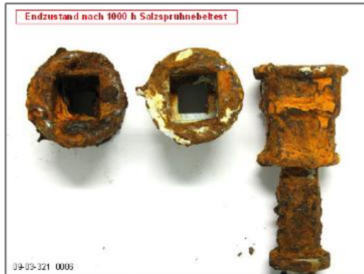
Abbildung 7: klassische metallische Kuppelmuffen nach 1.000 Stunden Salzsprühtest [3]
