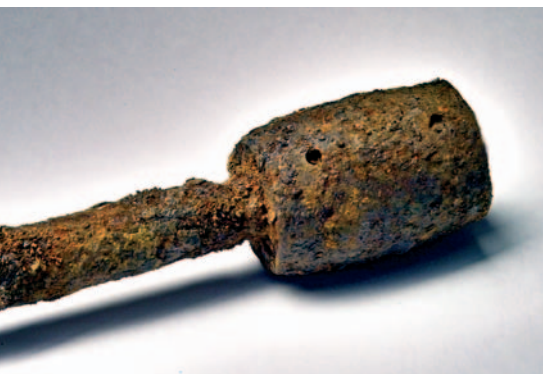
Bild 2: Stark verrostetes metallisches Kupplungselement
