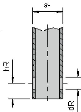
Abbildung 1.2: Schematische Darstellung der Kuppelmuffe im Bereich der Gestängeaufnahme
