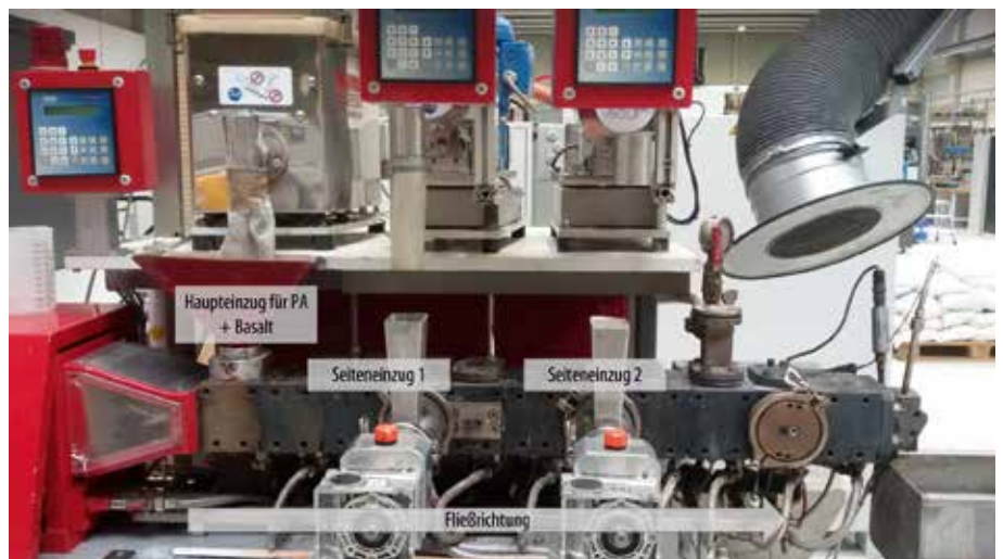
Bild 2. Übersicht der Zugabeorte bei der Compoundierung im Zweischnellencompounder
