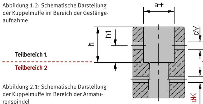
Abbildung 2.1: Schematische Darstellung der Kuppelmuffe im Bereich der Armaturenspindel
