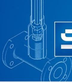
**Voraussetzung:** Das Schutzrohrsystem der EBG muss mit einer Rundglocke mit vonRoll-Innengewinde ausgestattet sein (siehe Darstellung).
