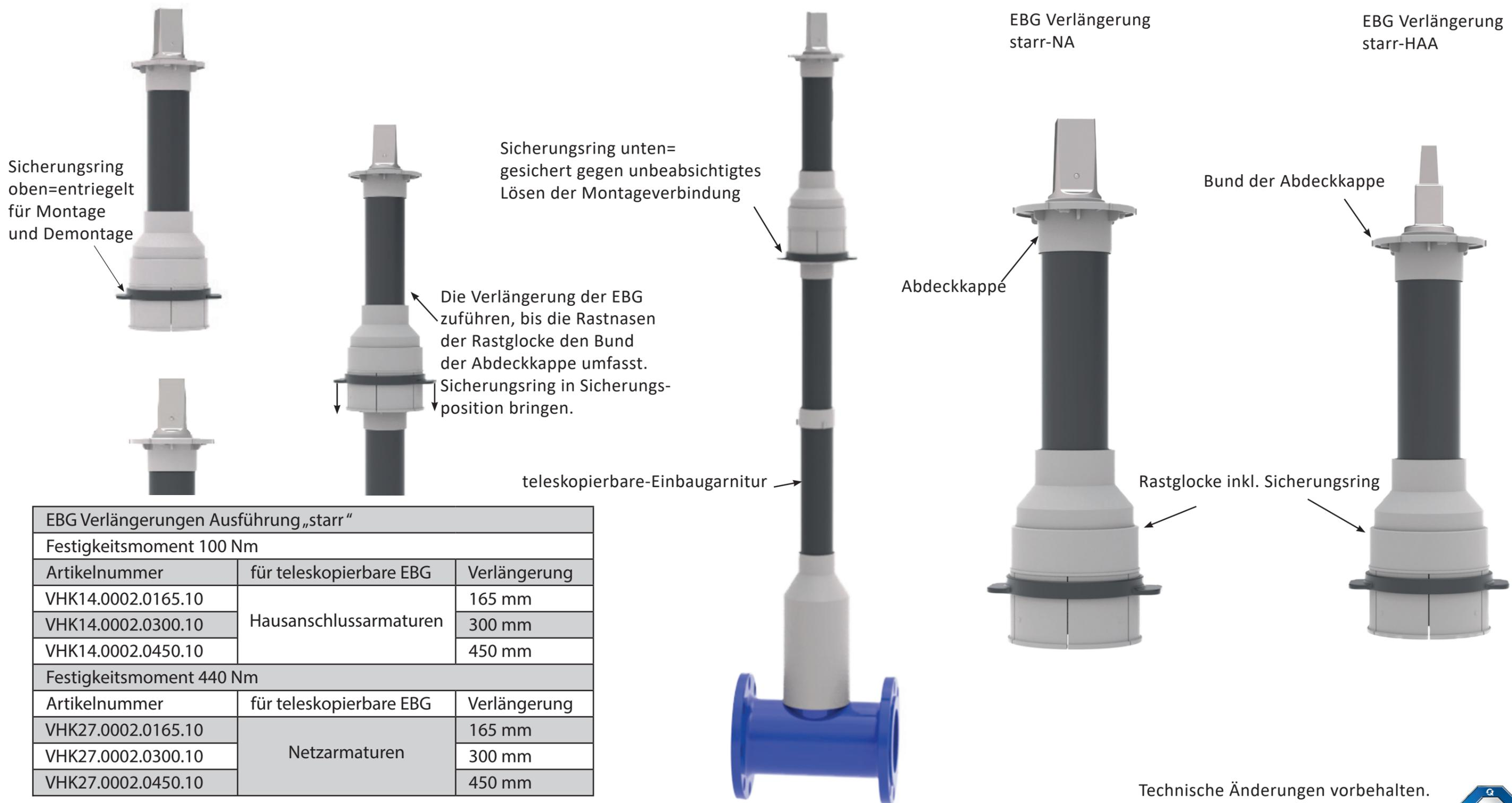
Sicherungsring oben=entriegelt für Montage und Demontage
