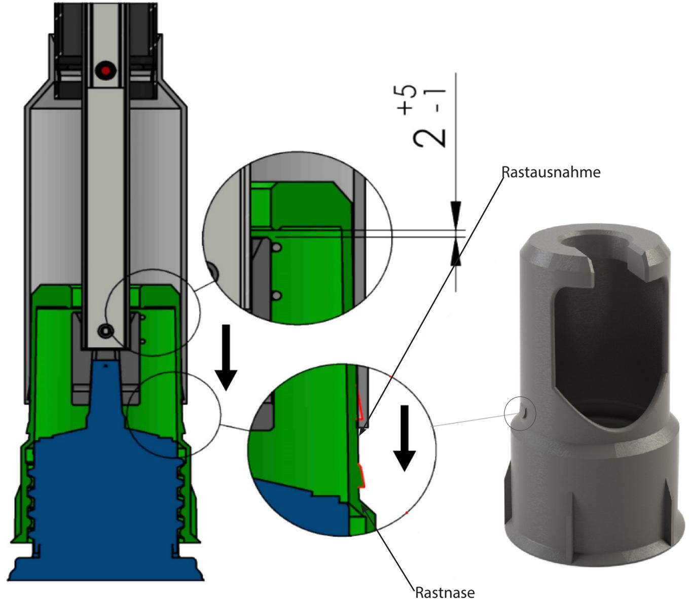
Erläuterung zur Verwendung des EBG-Adapters für die Herstellung der Verbindung zum Schieber DN 50 – 150 mit Außengewinde
