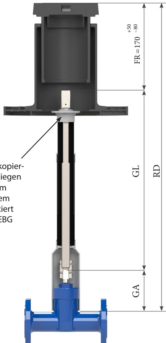
Erst mit dem absenken des teleskopierbaren Teils der EBG und dem aufliegen von dessen Abdeckkappe auf dem verdichteten Erdreich bzw. auf dem EBG-Fix, der auf der Tragplatte fixiert ist, ist die Höheneinstellung der EBG abgeschlossen.
