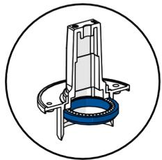
schmutzdicht (analog IP44),
