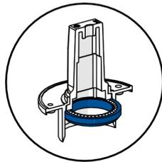
schmutzdicht (analog IP44),
