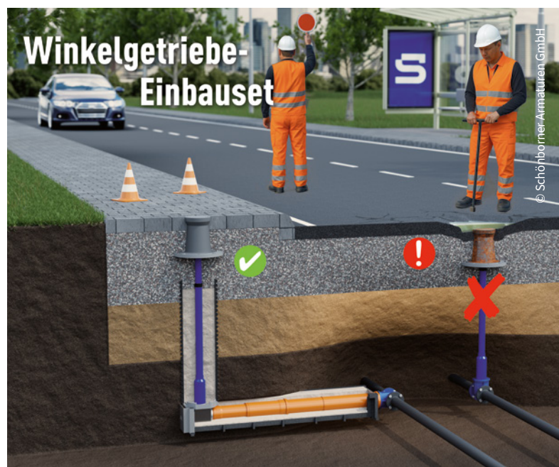
Bild 2: Winkelgetriebe-Einbauset der Schönborner Armaturen GmbH
