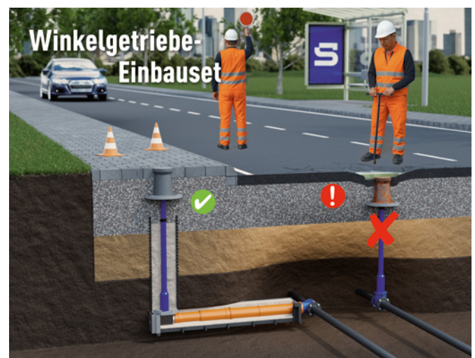
Bild 2: Mithilfe eines speziell entwickelten Winkelgetriebe-Einbausets wird die Betätigungsstelle der Armatur aus dem Fahrbahnbereich in angrenzende Geh- oder Radwege verlegt.
